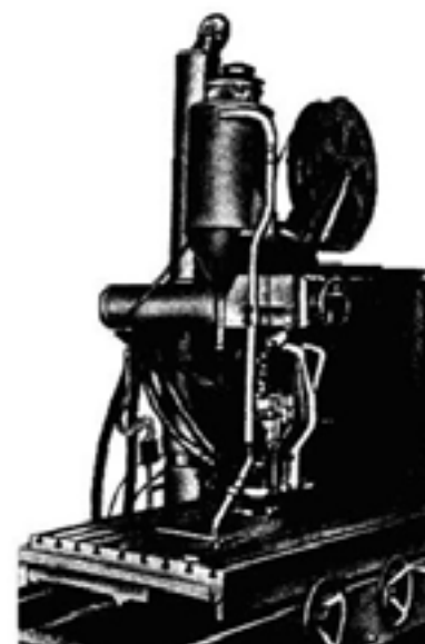
Первая лабораторная установка для сварки под флюсом, 1941 г.
